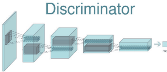
그림 3. 심층 합성곱 신경망으로 구성된 판별기 구조 예시[15]
